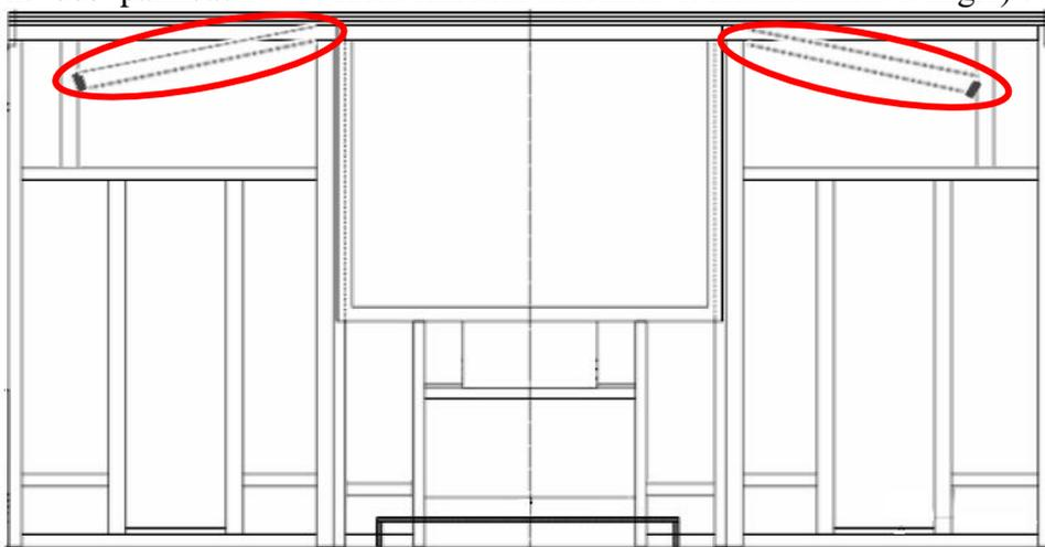
La structure arrière est assemblée à tenons et mortaises et chevillée. Elle aussi pourrait être de remploi, on remarque en effet deux trous rectangulaires en biais, d'où partent les traces de traverses en applique en écharpe (en haut des parties latérales).
